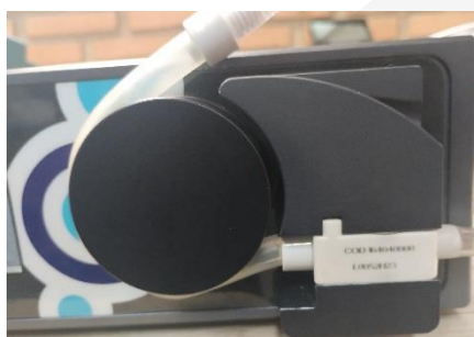
Figura 7 – Equipó de irrigação no frontal da Bomba passo 2 (Fonte: Próprio Autor).
