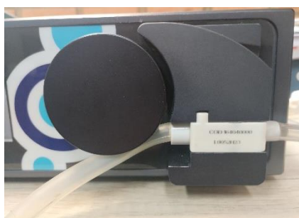
Figura 6 – Equipó de irrigação no frontal da Bomba passo 1 (Fonte: Próprio Autor).
